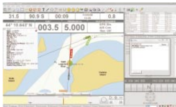
Widok na ekran NavCruiser z wyświetlonym układem ostrzeżenia i alarmu kolizyjnego ze statkiem VLISTBORG z pomocą systemu AIS. Zieloną dużą kropką zaznaczony jest rejon prawdopodobnego zbliżenia.
