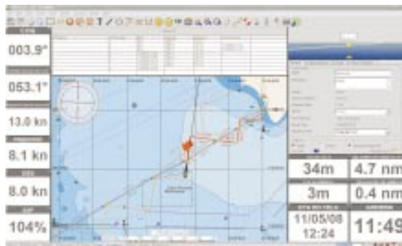
Widok na ekran SailCruiser z wyświetlonym ekranem aktualnej pozycji, prędkości i kursu jachtu w regatach Gdynia - Hel z wykorzystaniem GPS.
