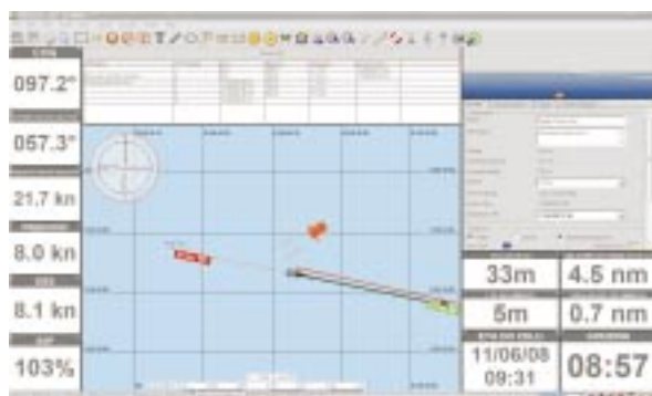
Widok na ekran SailCruiser z włączonym i ustawionym markerem MOB. System podaje odległość i namiar na MOB.
